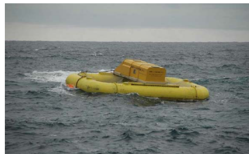
図 4.9 ジャイロ式(ドーナツ型試験機の海上実験)
