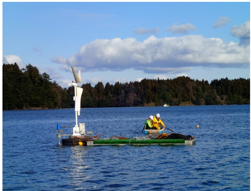
写真5：石川県穴水町における浮体式洋上風車の 実証試験写真2（曳航中）
