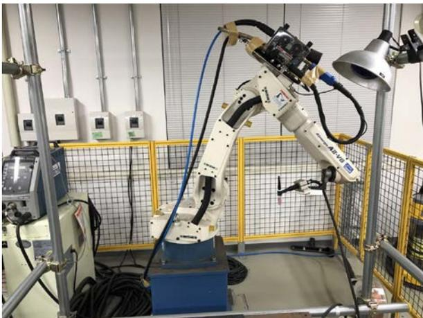
図4 溶接ロボット Almega A II-V6
