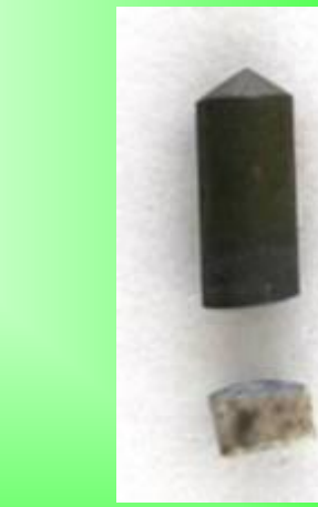
電極部分の割れ
